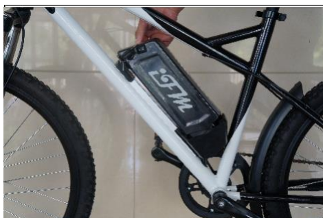
Figura 13- Estrazione della batteria dalla propria sede.
